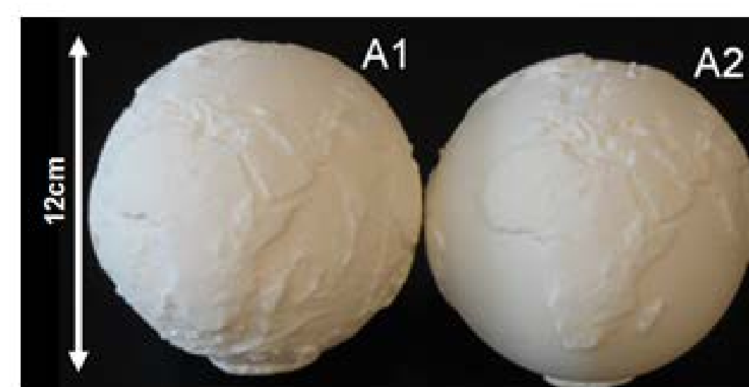
精確な地形データを基に 3Dプリンタで造形した地球儀 (A1, A2)
