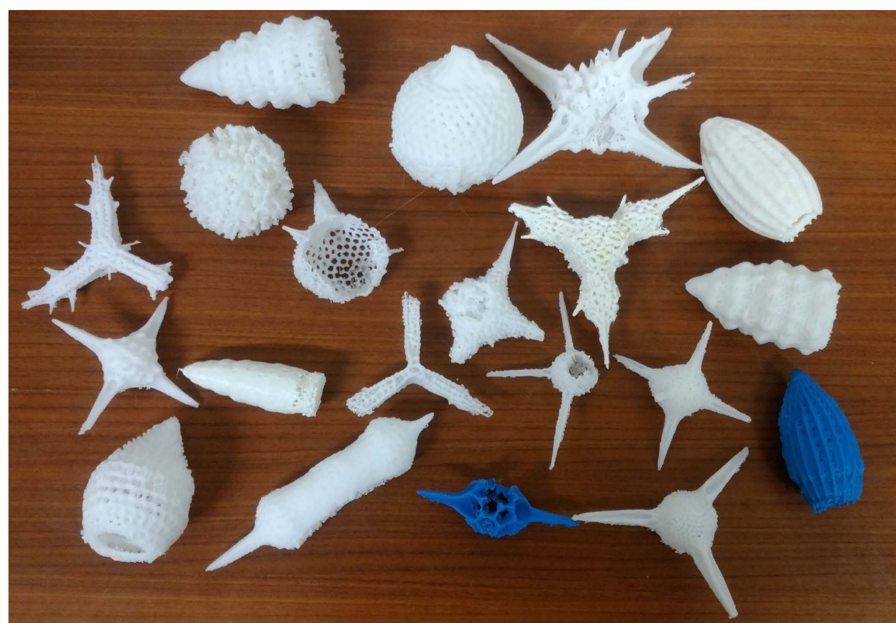
放散虫骨格の拡大模型の開発 (マイクロCTで微化石を撮影し、 3Dプリンタにより実体化)
