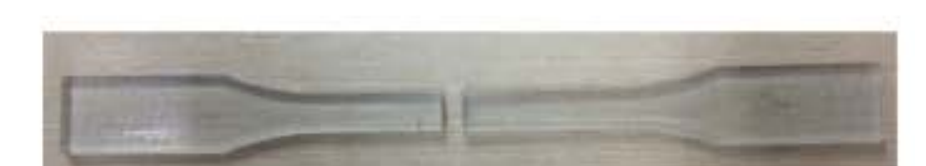
破断した試験片
